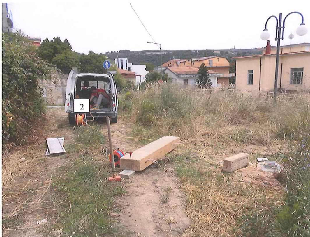
Foto 1 – Postazione sondaggio simico in foro denominato DH.2
