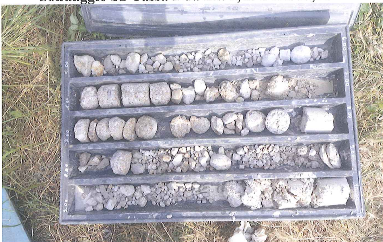
Sondaggio S2 Cassa 2 da mt. 5,00 a mt. 10,00
